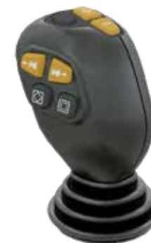
Опціональний джойстик регулює функції гідравлічних клапанів та трансмісії.
