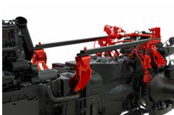
Напівактивна гідравлічна підвіска надійно поглинає поштовхи та вібрації.
