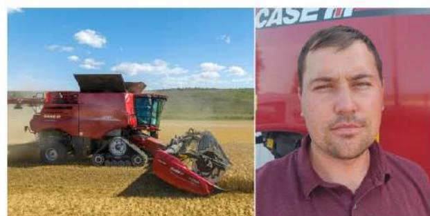
Жниварка FD2 – це гнучка трисекційна копіювальна система зі здвоєним або строєним мотовилом, що дозволяє їй точно слідувати контуром ґрунту. Це забезпечує рівномірне подання рослинності в комбайн навіть при максимальному згині.
